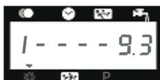
LA VANNE EST AU CYCLE 1 LE TEMPS RESTANT DU CYCLE EST DE 9.3 MINUTES
